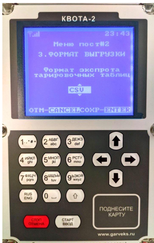
Рисунок 7 – Вид контроллера с лицевой стороны («Квота-2»)
